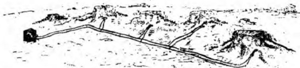
28. zīm. Lādiņu savienošana paraleli jeb līdztekus
