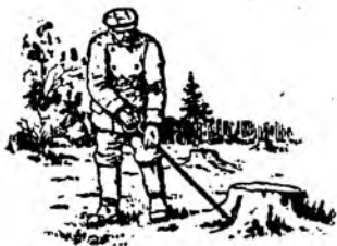
41. zīm. Urbšana noderīgas vietas atrašana ar iesma palīdzību.
